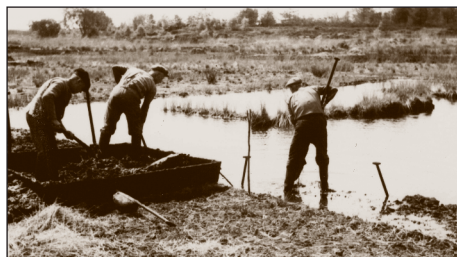
Afb. 4. In de Stippert wordt de baggel onder water gestoken met een baggelbeugel en in de baggelbak gegooid.
